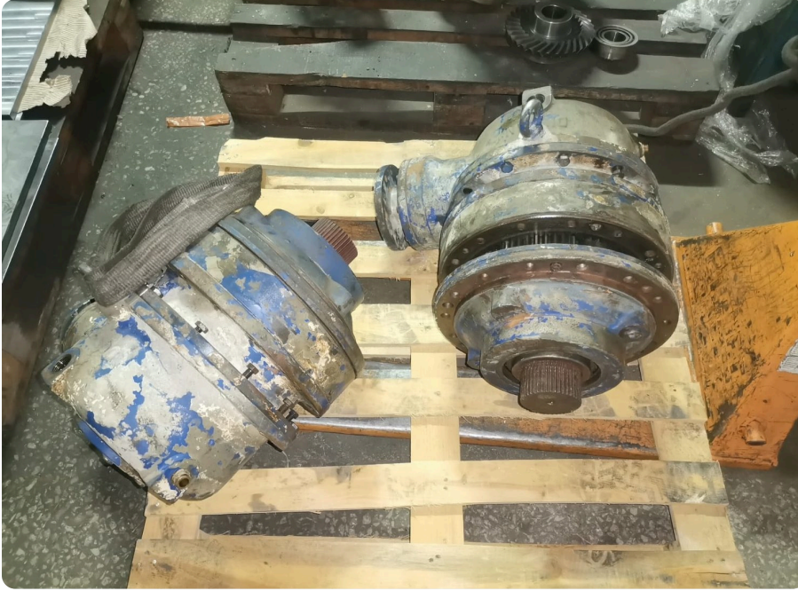
Revizyon için gelen şanzımanlar
