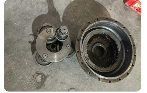
Kontrol için açılan planet kademesi
